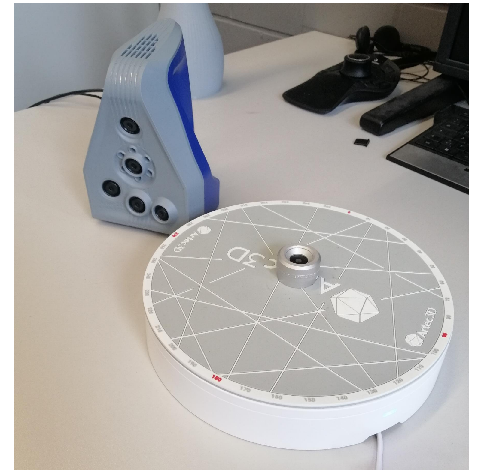
Artec Space Spider mit dem zugehörigen Artec Drehtisch
